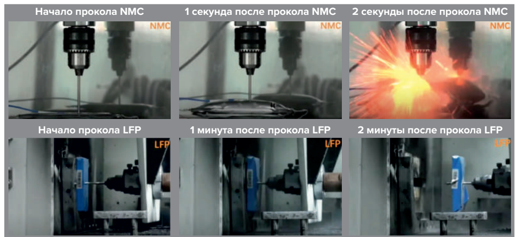
▲ Рис. 3. Тестирование литий-ионных элементов на устойчивость к механическим воздействиям
